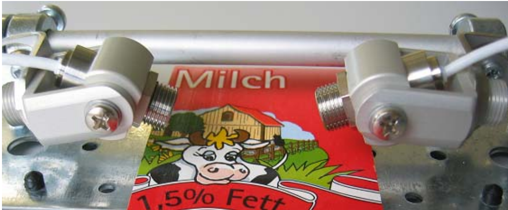
Abbildung 6-1 zeigt eine mögliche Ausrichtung der Messköpfe bei der Emissionsgradmessung
